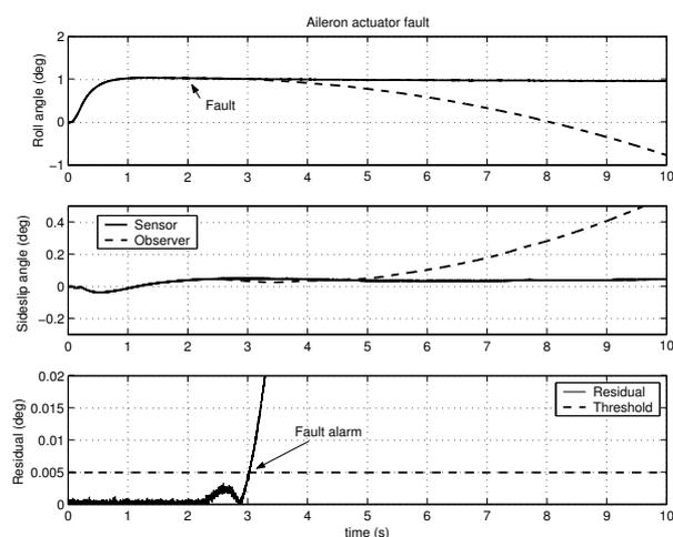
Fig. 4. Aileron actuator fault.
