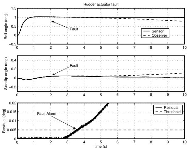
Fig. 5. Rudder actuator fault.
